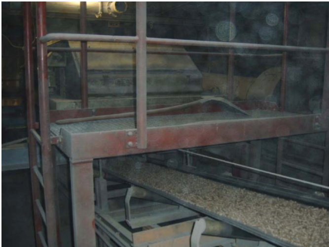
Abb. 2: Pelletierung ohne Staubabsiebung
