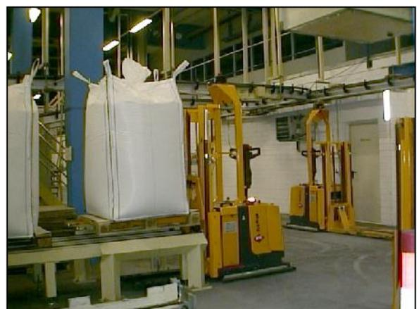
**Abbildung 4: automatische lasergesteuerte Gabelhubwagen**
