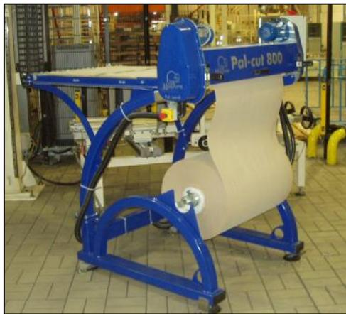
**Abbildung 6: automatischer Zwischenlagenzuschnitt**
