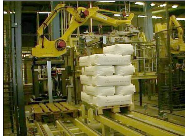
**Abbildung 5: Roboterpalettierung**
